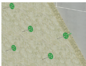
UNI-slagspouwanker Ø5 mm met Flex-5 plug
