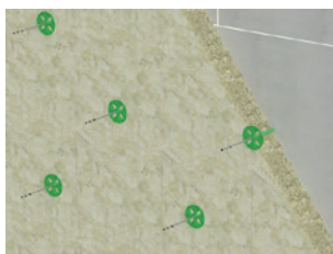
UNI-slagspouwanker Ø5 mm met Flex-5 plug
